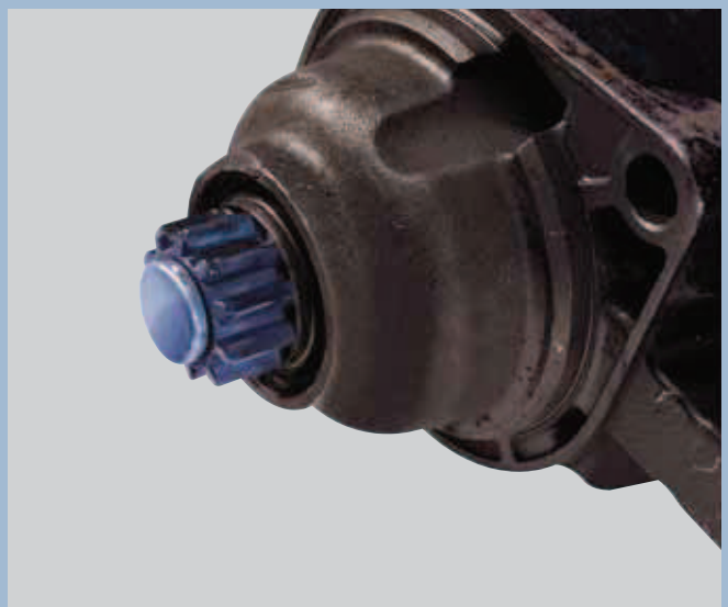
Kék futásnyomok a tengelyen (túlhevülési nyomok)
