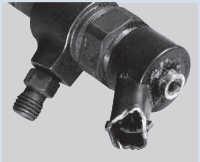
Sérülés az elektromos csatlakozón
