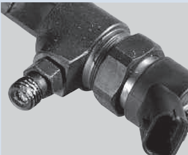
Sérülés a tömítő felületen, illetve a házon
