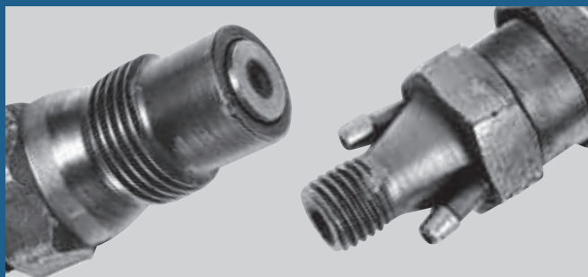
Sérülés a meneten vagy a tömítő felületen
