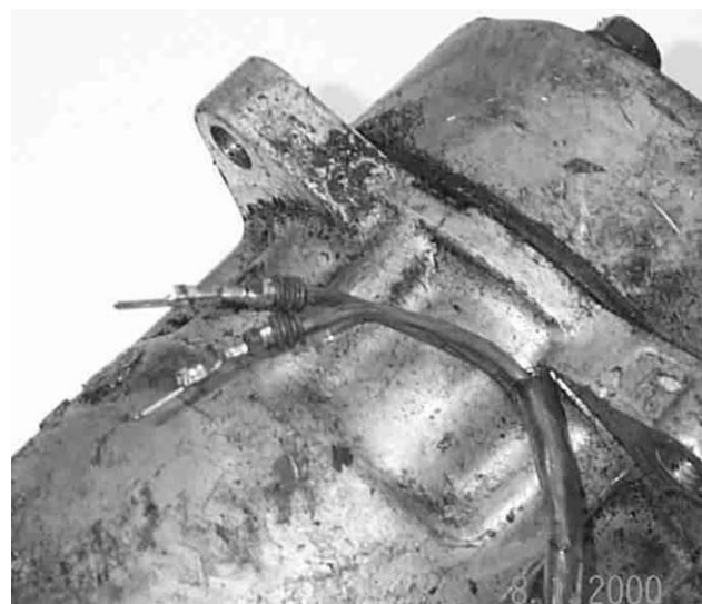
A kábelek le vannak ugyan vágva, de még meg lehet javítani / toldani őket.
