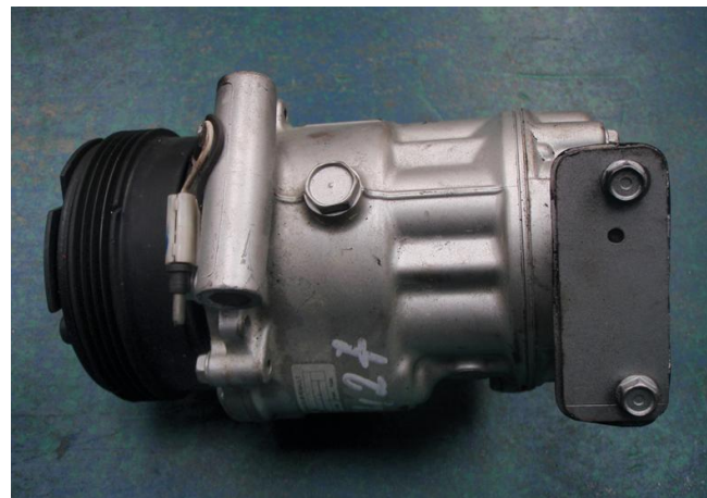
A befolyó / kifolyó nyílás műanyagdugóval van lezárva (használja az újonnan vett kompresszor dugóját).
